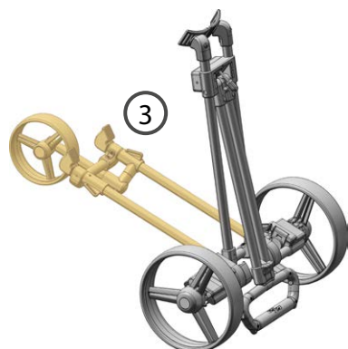
Vorderrad mit Ausleger ausklappen.
